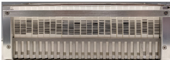
Figure 10 : Vue arrière du rack à cartouches avec des cartouches et des codes-barres 1D visibles
